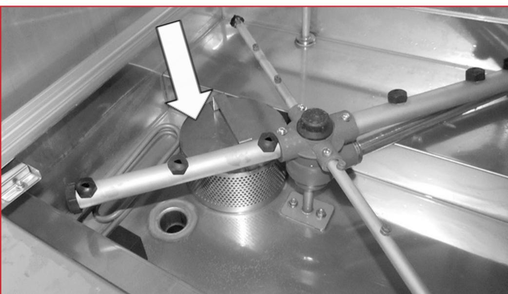
**1º** VERIFIQUE SE O FILTRO DA MOTO BOMBA ESTÁ DEVIDAMENTE ENCAIXADO NO ANEL DO TANQUE; E PRESSIONE-O PARA BAIXO ATÉ ENCOSTAR NO FUNDO DO TANQUE.
