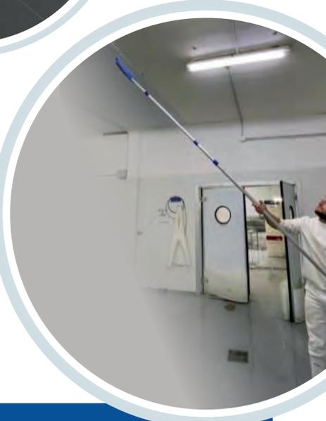
Secado de condensación en techos de áreas alimenticias. Se utiliza para recolectar la condensación de los techos de áreas productivas de temperaturas controladas. Goma de acción suave para una mejor recolección de la condensación. Modo: El agua queda en el recipiente y luego se escurre a través del cabo para finalizar en la botella recolectora.
